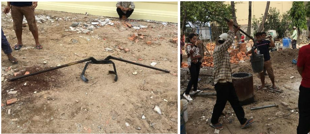
តឡៀបប្រើជាឧបករណ៍សម្រាប់ចាប់លើកប្រាក់ដាក់ចូលឡូប៊ីដែរលើកចេញពីឡូ
