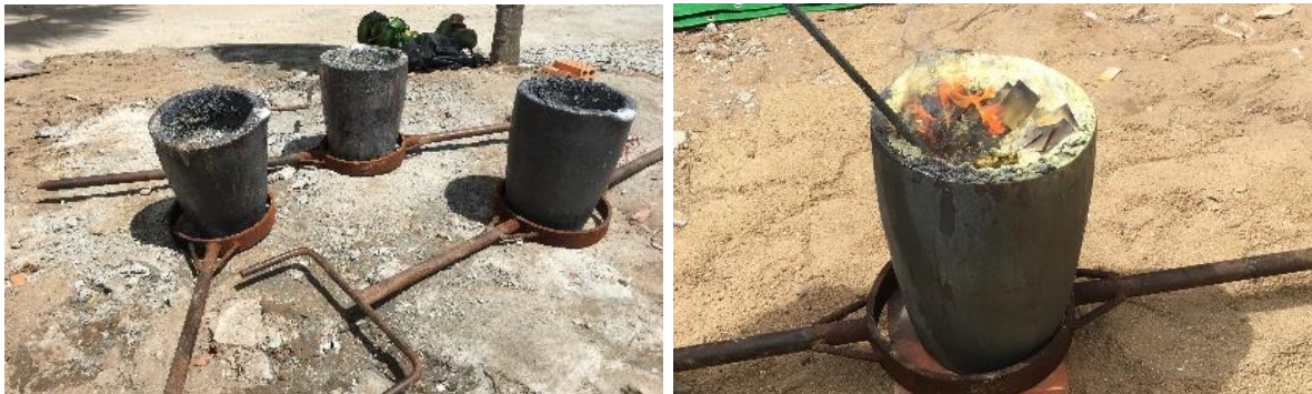
ប្រើប្រាស់ប៊ែនធីនប៊ែនប្រមាណដាក់ស្លាន់ស្នូននិងសម្រាប់សិតស្លាន់ (សម្រាប់ស្នូនឡូប៊ីដែរ) ដែលប្រើប្រាស់មួយអាចដាក់ស្លាន់បានចំណុះ ៧០គីឡូក្រាម។ ជារួម ជាងស្ថិតបានប្រើស្លាន់អស់ប្រមាណ ២០០គីឡូក្រាមសម្រាប់សិតបដិមាព្រះនាងឥន្ទ្រទេវីទាំងមូល ហើយបានចំណាយអស់រយៈពេលប្រមាណ ៣ម៉ោង ៣ ។
